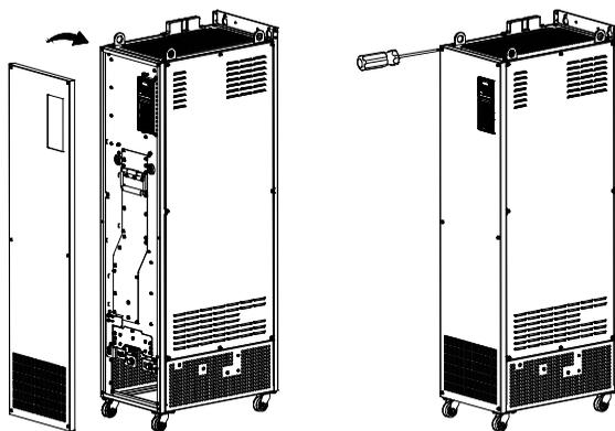
Рис. 3-11. Установка крышки
