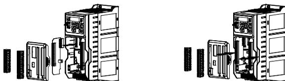
Рис. 3-18. Установка платы энкодера с 18-штырьковым разъемом
