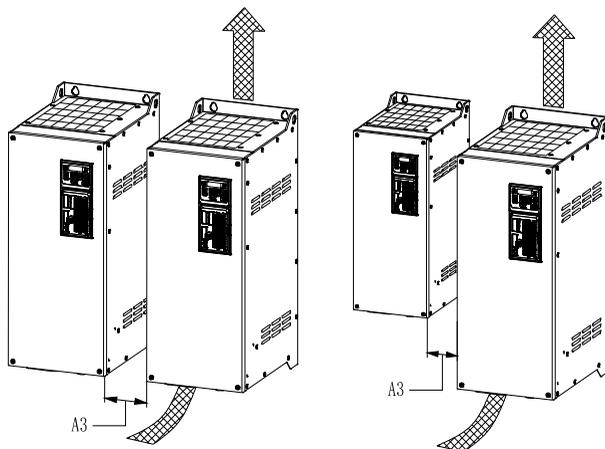
Рис. 3-3. Минимальные монтажные зазоры для приводов GK900-4T0.75GB – GK900-4T450G
