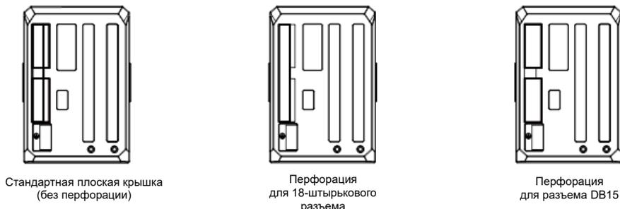
Рис. 3-16. Конфигурация перегородки на плате расширения энкодера
