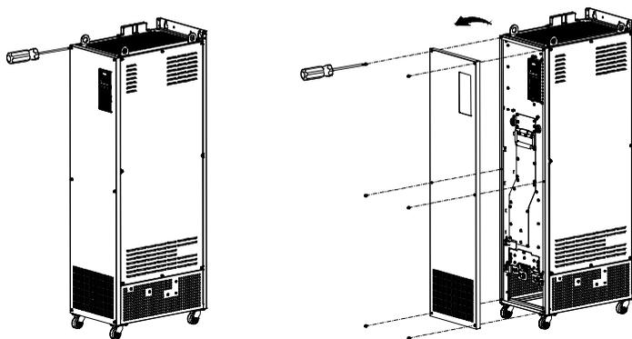
Рис. 3-10. Демонтаж крышки
