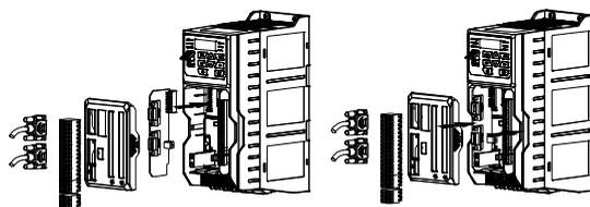
Рис. 3-20. Установка платы энкодера с разъемом DB15
