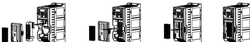
Рис. 3-13. Установка штатной платы ввода-вывода и платы расширения
