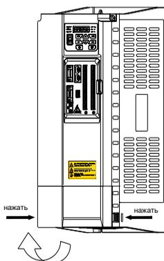
Рис. 3-6. Снятие крышки
