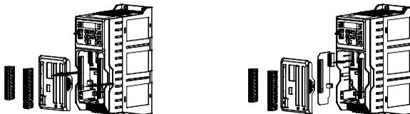
Рис. 3-17. Демонтаж и установка платы энкодера с 18-штырьковым разъёмом
