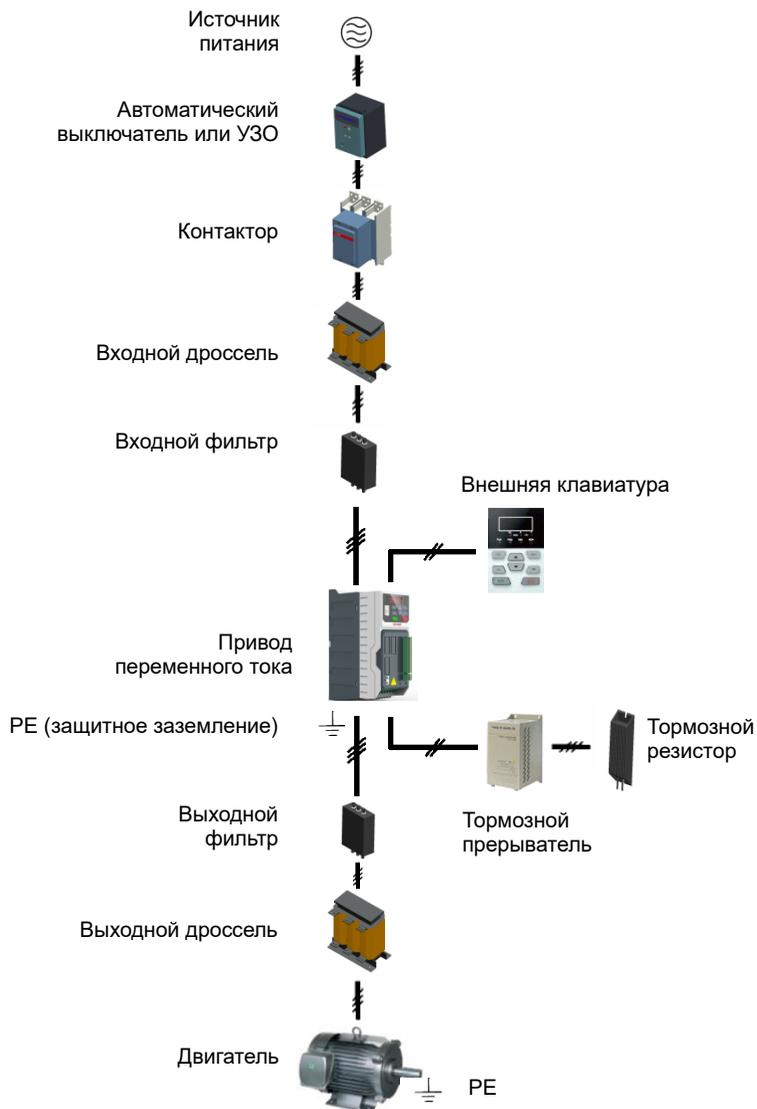
Рис. 3-21. Стандартная конфигурация периферийных устройств
