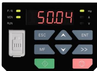
Рис. 4-7. Режим прямого изменения частоты
