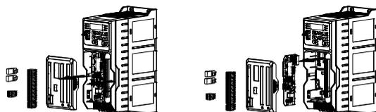
Рис. 3-14. Демонтаж и установка коммуникационной платы
