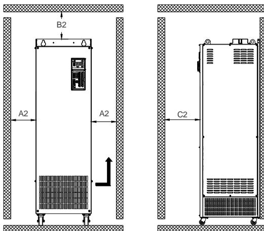
Рис. 3-2. Монтажные зазоры для приводов GK900-4T250G – GK900-4T450G
