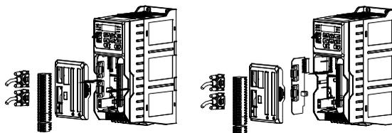
Рис. 3-19. Демонтаж платы энкодера с разъемом DB15
