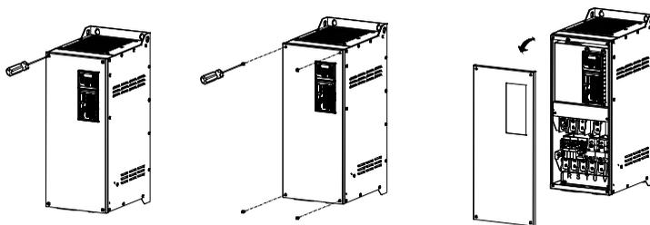
Рис. 3-8. Демонтаж крышки
