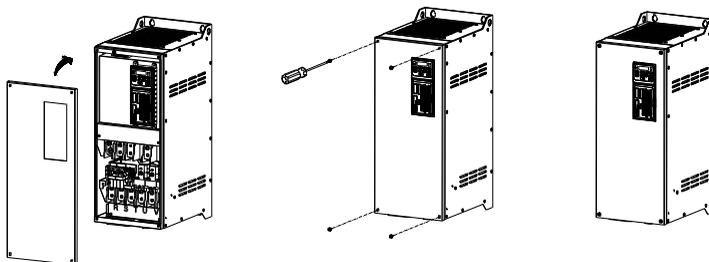
Рис. 3-9. Установка крышки
