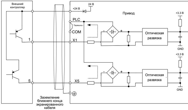
Рис. 3-33. Подключение внутреннего источника питания с открытым коллектором
