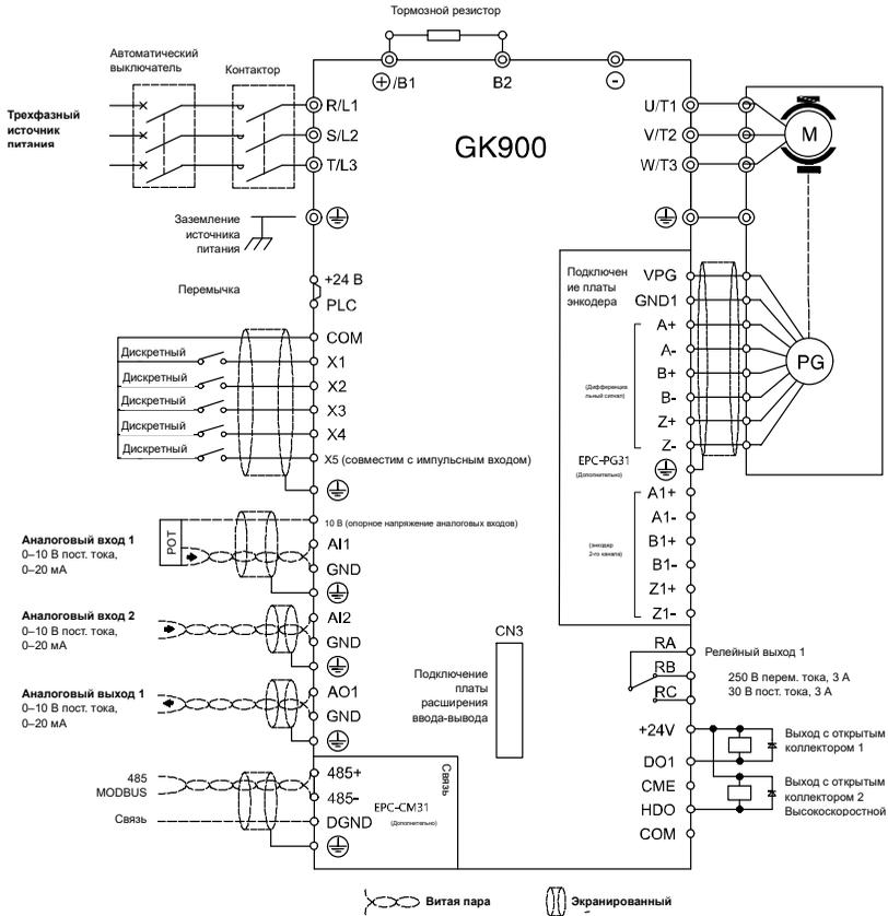
Рис. 3-24. Схема подключения
