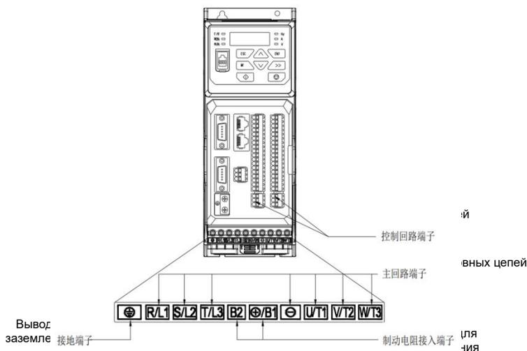
Рис. 3-22. Конфигурация выводов
