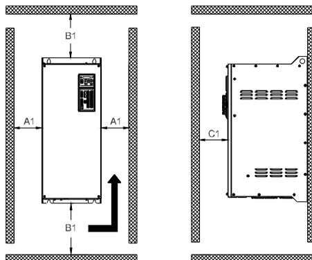
Рис. 3-1. Зазоры при монтаже привода (GK900-4T0.75GB – GK900-4T220G)
